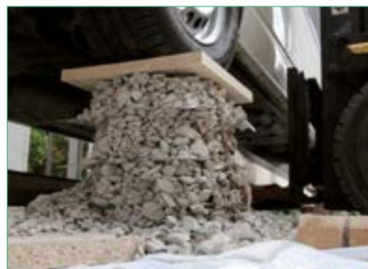
Figure 7 : Illustration de l'interaction sol-géogrille avec un véhicule posé sur une colonne de gravier renforcée avec la Secugrid®
