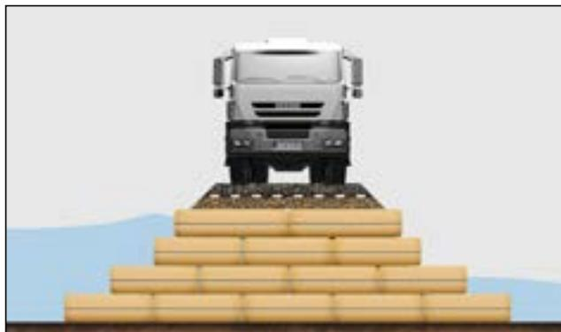
Fig. 3 : Digue temporaire avec les conteneurs de sable Secutex® Soft Rock
