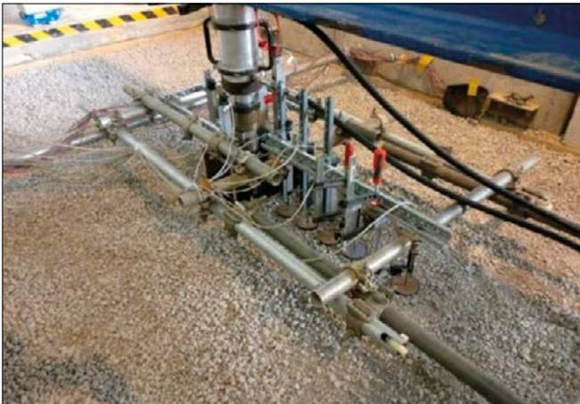
Figure 4 : Essai en laboratoire à grande échelle : Essais de charge sur des plates-formes de travail renforcées et non renforcées par des géo grilles
