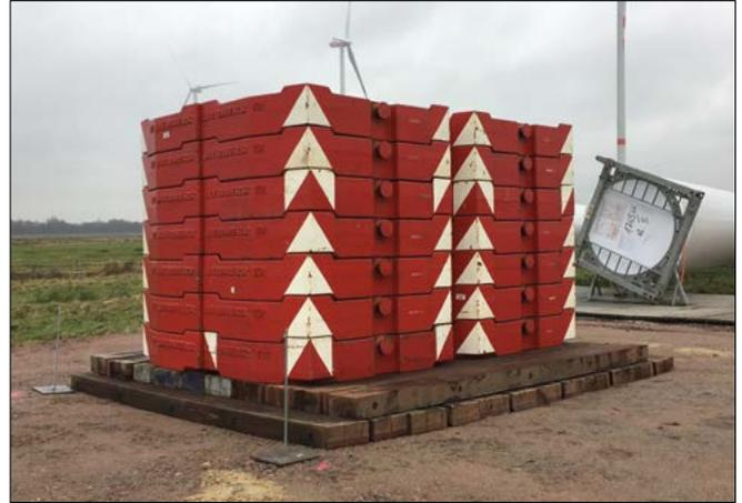
Figure 5 : Essai sur site en grandeur réelle : Essai de charge sur une plate-forme de travail stabilisée et renforcée par une géo grille
