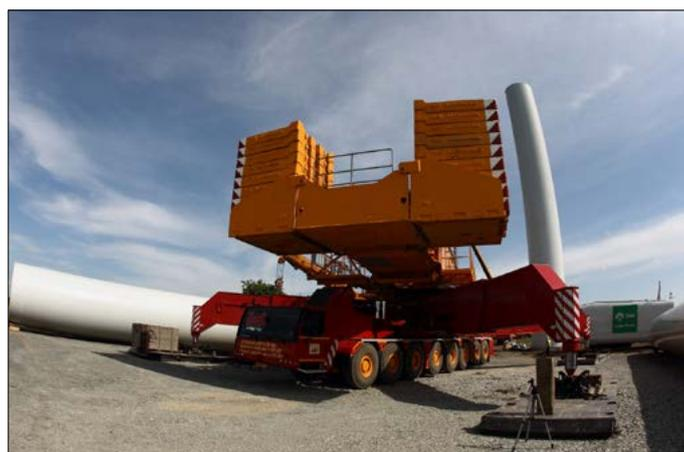
Figure 1 : Charge maximale de 250 t lors d'un essai sur site en grandeur réelle, parc éolien de Salbatca II, Roumanie
