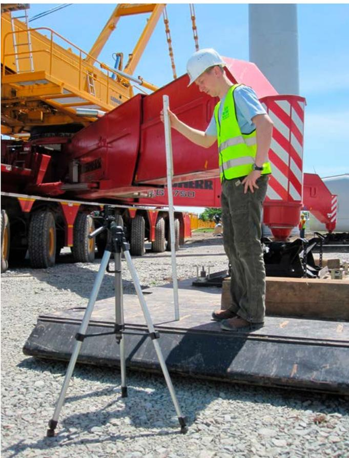
Figure 3 : Mesure des tassements, des contraintes et des déformations, parc éolien de Salbatca II, Roumanie
