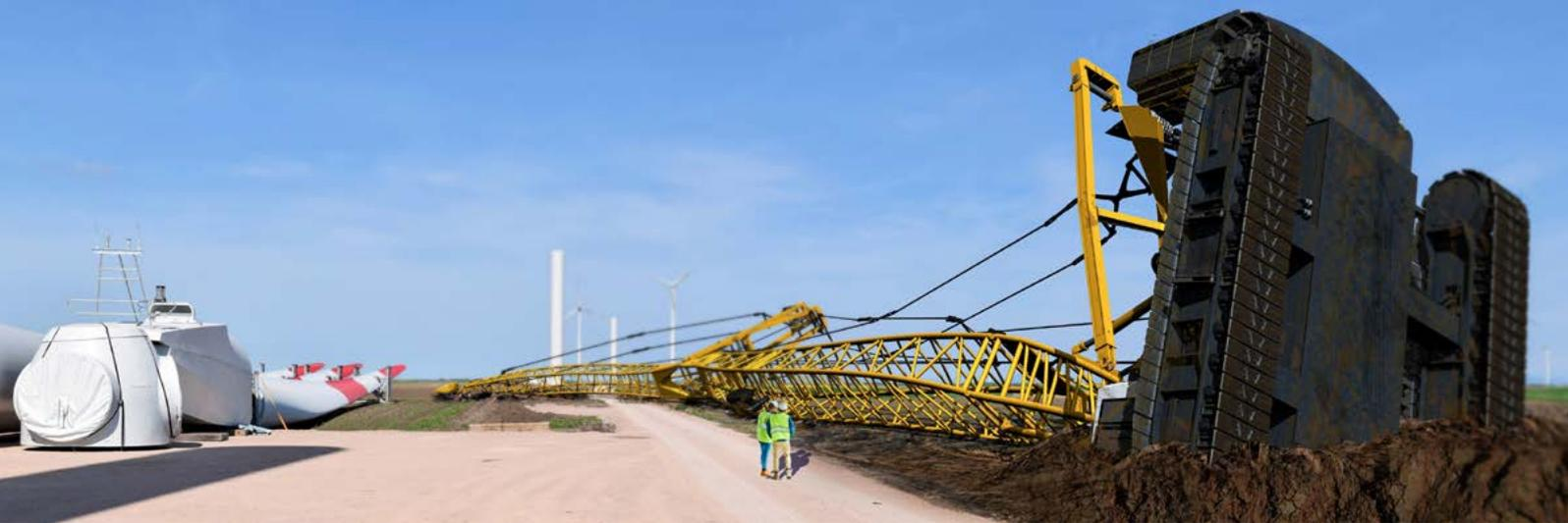
Chaque année, des grues, des engins de levage et de forages mobiles se renversent ou sont instables à cause d'une mauvaise préparation ou d'un mauvais entretien sur le site. Ce type de situation peut entraîner des accidents mortels, des blessures graves et des dommages importants aux équipements.
