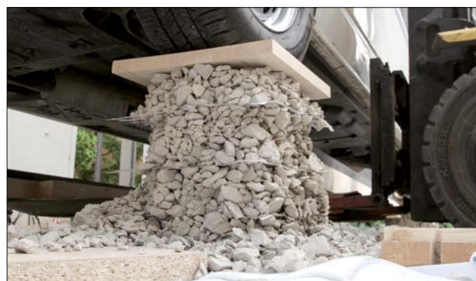
Fig. 2 Illustration de l'effet de verrouillage (interlocking) sous un fourgon de 2,2 t
