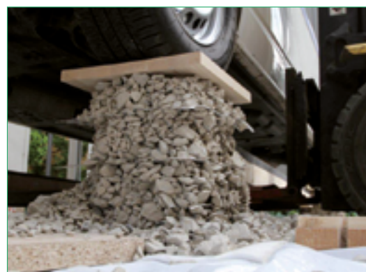
Abbildung 7: Verzahnungseffekt am Beispiel einer mit Secugrid® bewehrten Schotterssäule, die einen Lieferwagen trägt
