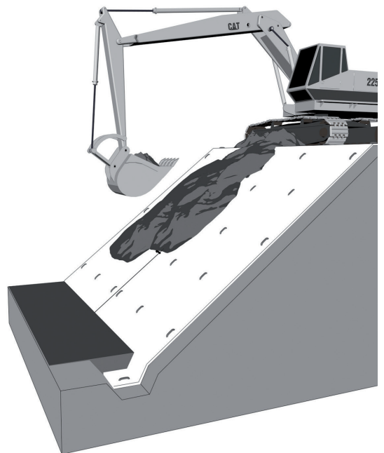
Abb. 10 Einbringen des Bodens mit technischem Gerät
