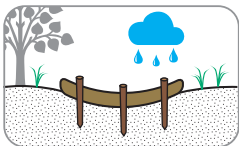
Abbildung 2: Kokosnetz im Deichbau
