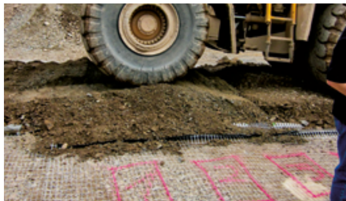
Abbildung 15: Bestimmung der Einbaubeschädigungen („A2-Faktor“) im Feldversuch in einem Steinbruch
