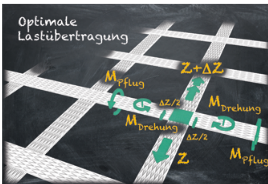
Abbildung 18: Wirkungsweise der Kräfte im Verbindungsbereich
