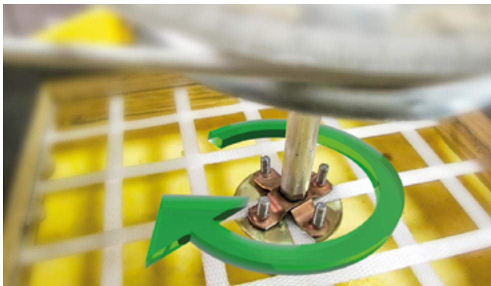
Abbildung 13: Torsionsbeanspruchung von Secugrid® im Prüfgerät
