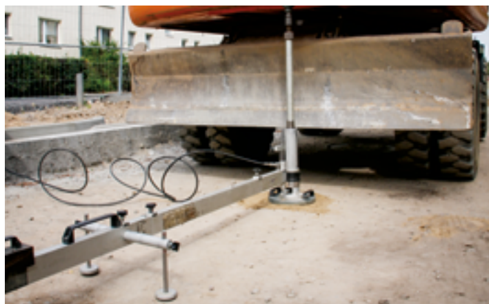
Abbildung 19: Lastplattendruckversuch nach DIN 18134 mit einer 300 mm runden Lastplatte
