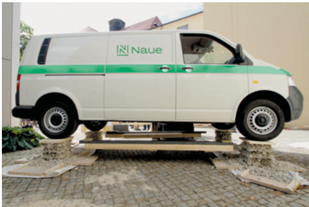
Abbildung 2: Mit Secugrid® Geogitter bewehrte Schotterauflager tragen den fast 2 Tonnen schweren Transporter in einem Live-Versuch (s. nachfolgender QR-Code)
