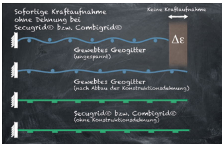
Abbildung 12: Secugrid®/Combigrig® Produkte ohne Konstruktionsdehnung übertragen im eingebauten Zustand auftretende Kräfte sofort
