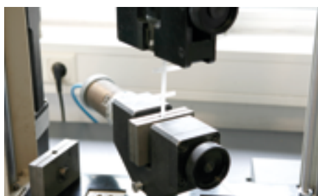
Abbildung 17: Knotenfestigkeitsprüfung durchgeführt an einem Secugrid® Muster
