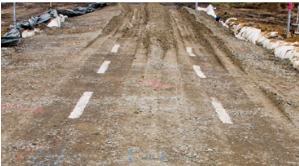
Abbildung 21: Geringe Spurrinnentiefe im Secugrid® geogitterbewehrten Feld (vorne) im Vergleich zum unbewehrten Feld (hinten)
