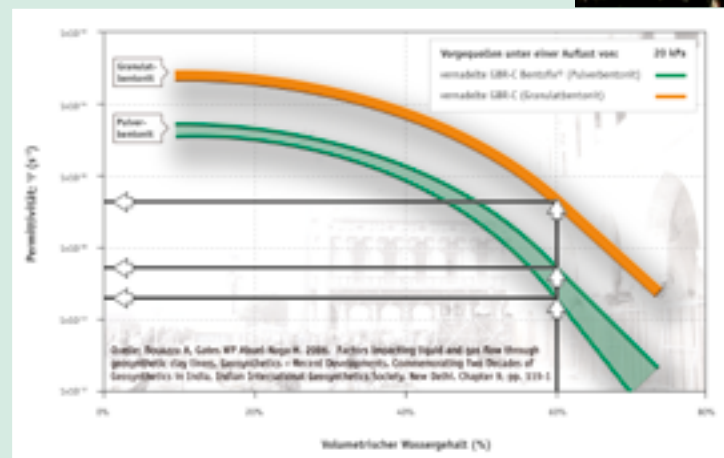
Abbildung 2 Verhalten der Gaspermeabilität von Bentofix® (Bentonitpulver) gegenüber Bentonitgranulat in Abhängigkeit vom Wassergehalt des Bentonits
