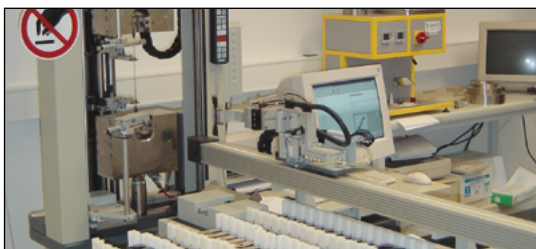
Tensile test on Carbofol® geomembranes (EN ISO 527)
