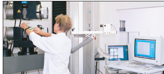
Tensile strength test of Secugrid® geogrids (EN ISO 10319)
