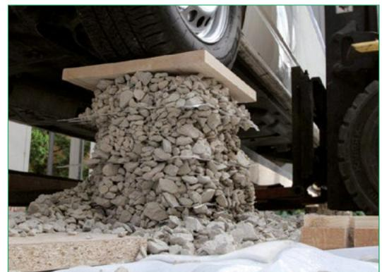
Abbildung 7: Verzahnungseffekt am Beispiel einer mit Secugrid® bewehrten Schottersäule, die einen Lieferwagen trägt
