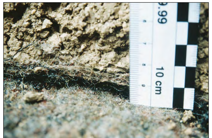
Bild 10 In-Situ Dickenmessung von Secudrain® an einer über 12 Jahre belasteten Feldprobe mit 1,20 m Bodenbelag
