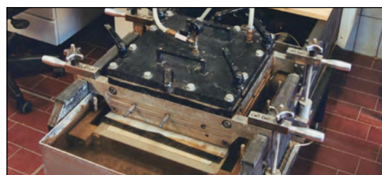
Schergerät zur Bestimmung von Reibungsbeiwerten EN ISO 12957
