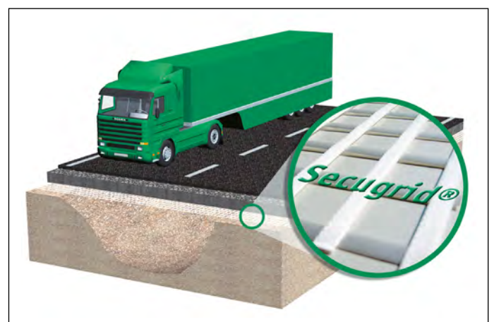
Bild 79 Secugrid® Geogitter zur Sicherung von Verkehrswegen über Erdfallgebieten
