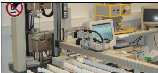
Zugversuch an Carbofol® Kunststoffdichtungsbahnen nach EN ISO 527
