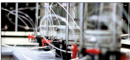
Bestimmung der Permittivität von Bentofix® geosynthetischen Tondichtungsbahnen DIN 18130, bzw. ASTM D 5887
