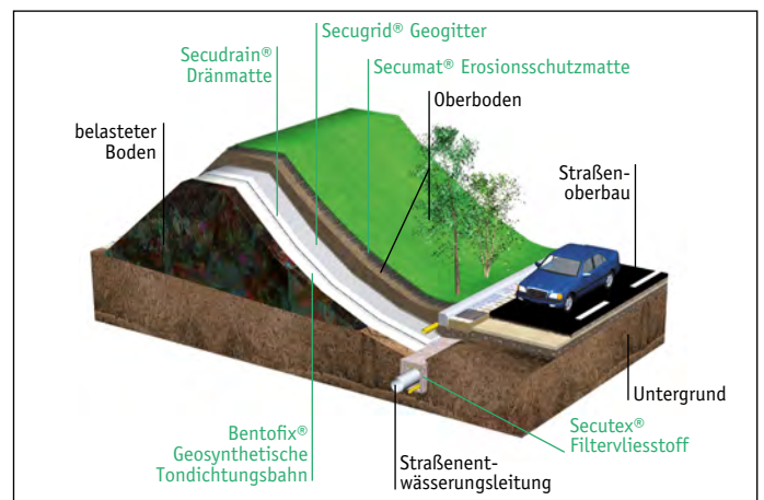
Bild 51 Sicherungsmaßnahmen beim Einsatz von Böden mit umweltrelevanten Inhaltsstoffen nach dem FGSV-Merkblatt M TS E
