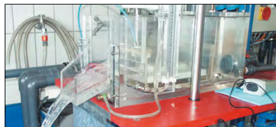
Bestimmung der hydraulischen Eigenschaften von wasserdurchlässigen Geokunststoffen EN ISO 12958
