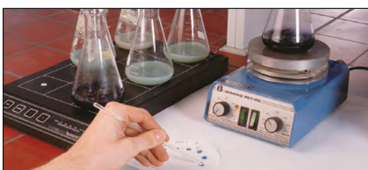
Bestimmung des Montmorillonitgehaltes von Bentonit nach der Methylen-blau-Adsorptions-Methode VDG P69
