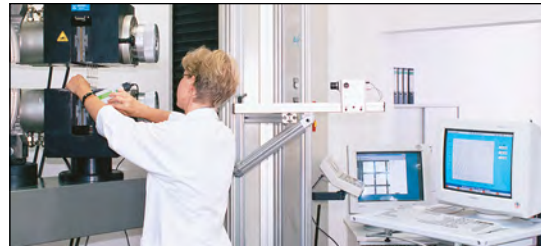
Zugversuch an Secugrid® Geogittern EN ISO 10319
