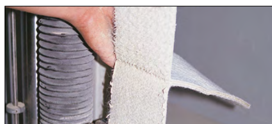
Bestimmung der Verbundfestigkeit von Bentofix® geosynthetischen Tondichtungsbahnen im Schälversuch ASTM 6496
