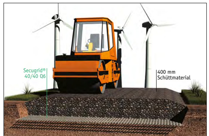
Bild 30 Querschnitt einer tragschichtbewehrten Zufahrtsstraße zu einer Windparkanlage
