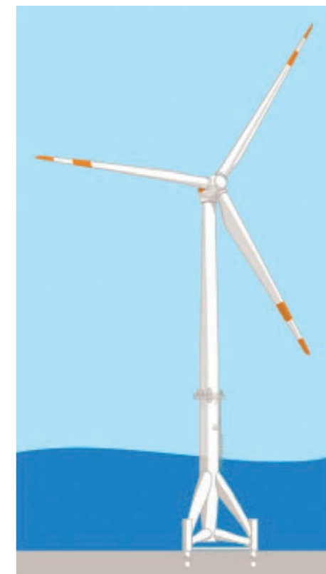
Bild 4. Multibrid M5000 auf „alpha ventus“ installiert. Fig. 4. Multibrid M5000 installed on „alpha ventus“.
