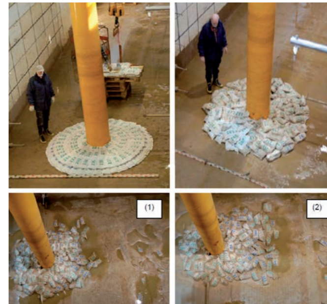
Bild 6. 1:10-Modell für Kolktschutzvarianten mit geotextilen Sandcontainern im Großen Wellenkanal (GWK) in Hannover (links: gezielt abgelegte Sandcontainer, rechts: ungeordnet geschüttete Sandcontainer), vor (oben) und nach (unten) Wellenbeanspruchung.
