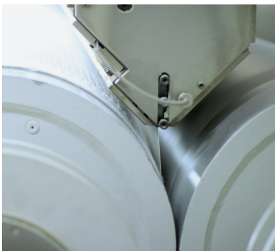
Abb. 6 Aufbringung der extrudierten Polyethylenbeschichtung auf das Bentofix®-Trägergewebe
