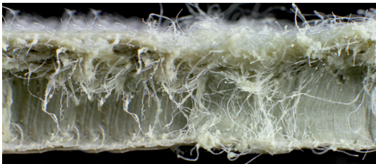
Abb. 1 Bentofix®, die original vernadelte geosynthetische Tondichtungsbahn
