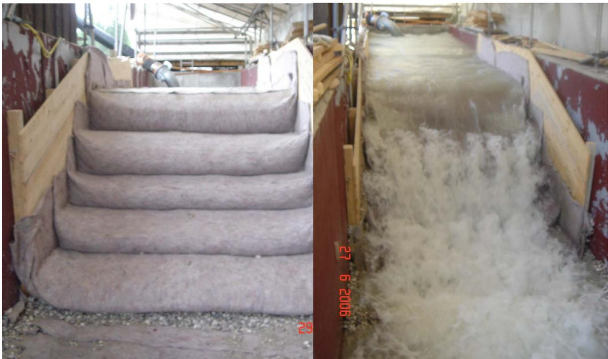
Abb. 25: Versuche am 1:1 Modelldeich der TU München zur Überströmung der Binnenböschung nach Methode (III). Links: vor Überströmung, rechts: im überströmten Zustand (aus: Haselsteiner et al., 2007)
