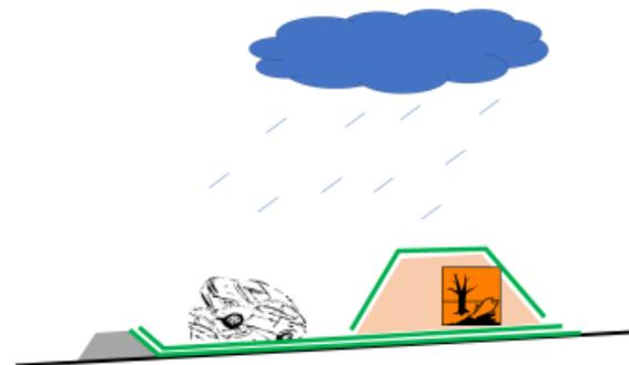
Abdichtung der Auflagerfläche oder vollständige Einkapselung mit Abdichtungssystemen aus Geokunststoffen, z. B. Bentofix® X, Carbofol®
