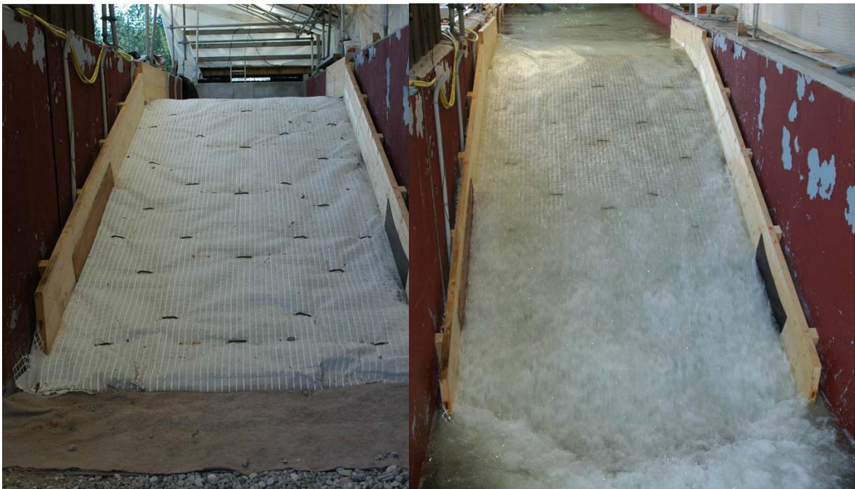
Abb. 23: Versuche am 1:1 Modelldeich der TU München zur Überströmung der Binnenböschung nach Methode (II). Links: vor Überströmung, rechts: im überströmten Zustand (aus: Haselsteiner et al., 2007)
