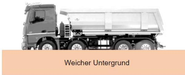
Abb. 4: Befahrung von gering tragfähigen Böden
