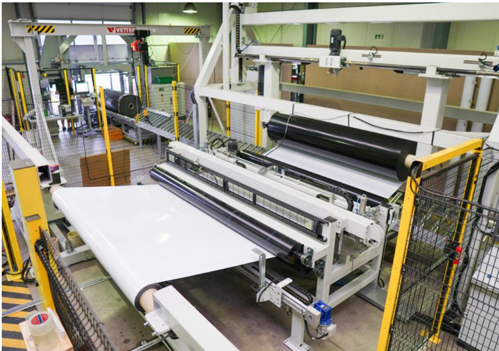
Abbildung 1: Konfektionierung von Carbofol®
