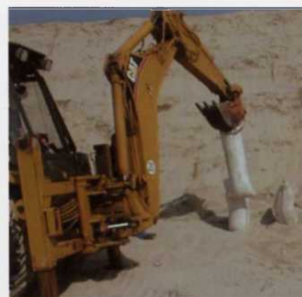
Abb. 5: Umgebauter Schürfkübel als Trichter zum Laden (links), Füllen (mittig) und Verdichten (rechts)
